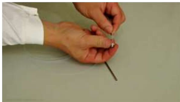
Abbildung 1.2-2 Schieben Sie den PTFE-Schlauch wie gezeigt durch die Befestigungsmutter.
