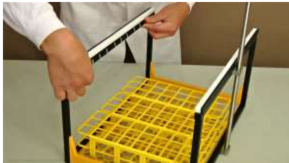
Abbildung 3.3-6 Legen Sie das magnetische Kodierband auf die Innenseite des linken Metallrahmens des Fraktionssammlers.
