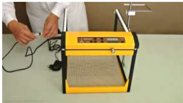
Abbildung 1.1-10 Verbinden Sie das Kabel der Steuereinheit des LAMBDA OMNICOLL Fraktionssammlers & Probennehmers mit dem Kabel des Netzsteckers. Erhältliche Steckertypen: AU, CH, EU, US, UK.
