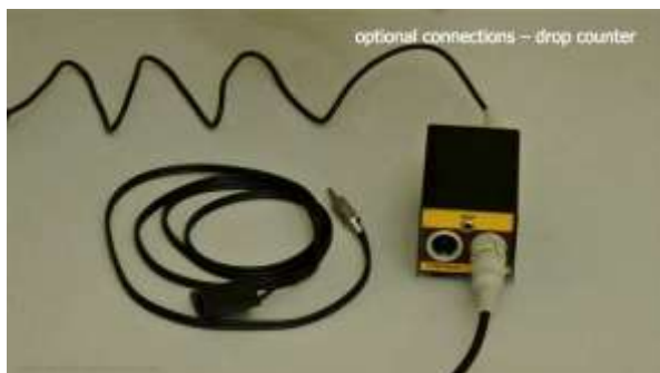
Abbildung 1.3-1 Der Tropfenzähler-Detektor mit Kabel (Art. Nr. 6926) für den Fraktionssammler und das Kommunikationsmodul für die Tropfenzählerelektronik (Art. Nr. 6929)
