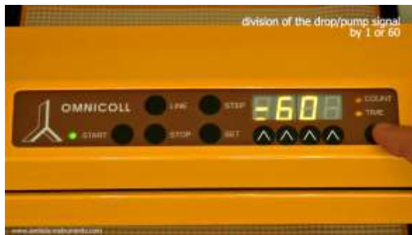
Abbildung 3.4-11 Auf der Anzeige des Fraktionssammlers erscheint „div“ und danach „=01“ oder „=60“.
