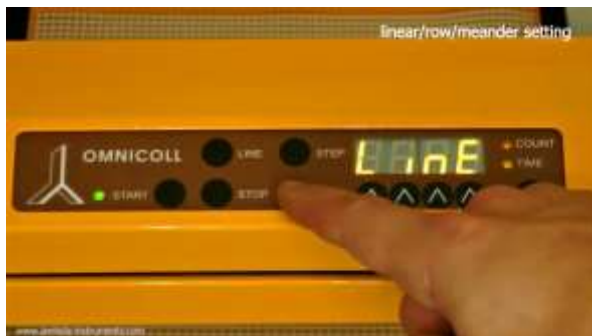
Abbildung 3.4-5 Sobald der gewünschte Betriebsmodus auf dem Display erscheint, bestätigen Sie Ihre Auswahl, indem Sie die Taste SET drücken.
