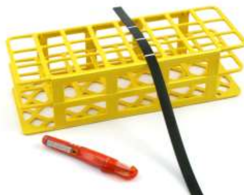
Abbildung 3.1-4 Der Abstand zwischen den Reihen wird ähnlich kodiert. Falls der Fraktionssammler nach der ersten Reihe automatisch ausschalten soll, zeichnen sie die letzte Linie etwa 1 cm breit ein.
