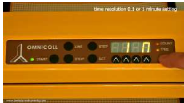
Abbildung 3.4-7 Die aktuelle Zeitauflösung erscheint auf der Anzeige: „0.1 M“ für 0.1 min oder „1 M“ für 1 min.
