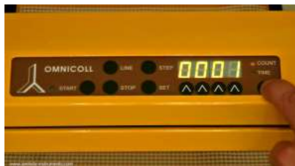
Abbildung 3.6-2 Am Autosampler wählen Sie mit der COUNT/TIME Taste den Modus COUNT. Die COUNT Diode leuchtet daraufhin auf.
