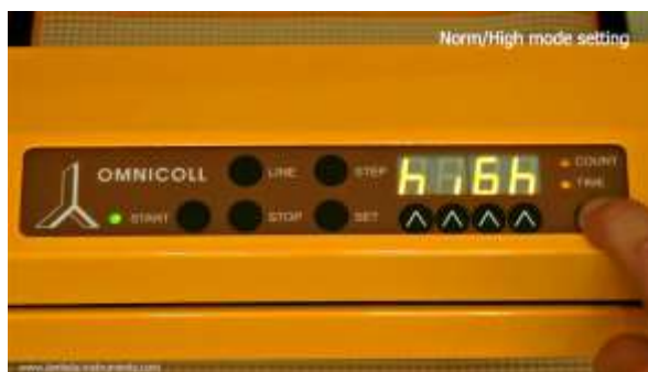
Abbildung 3.7-2 Wählen Sie am Autosampler mit der Taste COUNT/TIME den Modus "high" aus.
