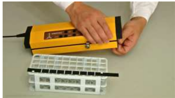
Abbildung 3.2-2 Ziehen Sie die Halterung für das kürzere, breitere Kodierband (x-Achse) aus der mobilen Kontrolleinheit des Fraktionssammlers.
