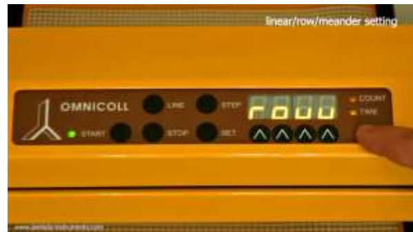
Abbildung 3.4-2 "rouu" für den Betriebsmodus „Reihe“ erscheint auf der Anzeige. Drücken Sie nun die Taste SELECTION in der unteren rechten Ecke (unterhalb der Leuchtdioden COUNT / TIME), um den gewünschten Betriebsmodus für die Fraktionierung auszuwählen.
