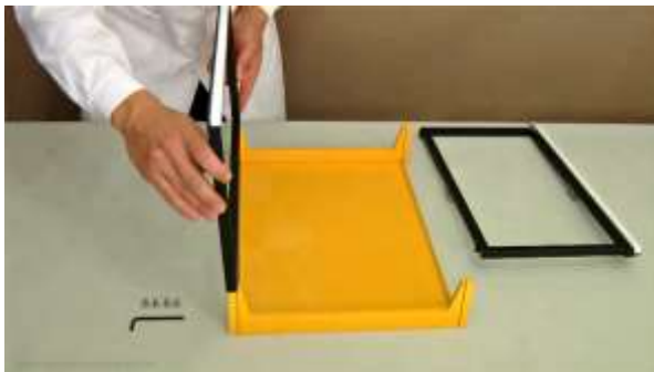
Abbildung 1.1-3 Stecken Sie einen der beiden schwarzen Rahmen in die entsprechenden Spalten der Wannenbleche. Achten Sie darauf, dass Sie beidseitig gleich schnell arbeiten, damit nichts blockiert.
