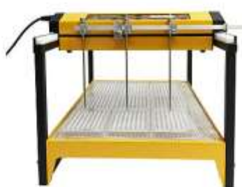
Abbildung 3.8-1 Beispiel Multikanal-Fraktionssammlung für 3 simultanen Ströme in Microtiterplatten. (Die Position der Kanülen ist innerhalb der Reihe anpassbar.)
