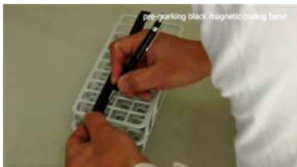
Abbildung 3.3-1 Legen Sie das schwarze Kodierstreifen auf das Reagenzglasrack, und markieren Sie die Positionen der Reagenzgläser mit einem Bleistift auf dem Kodierband.
