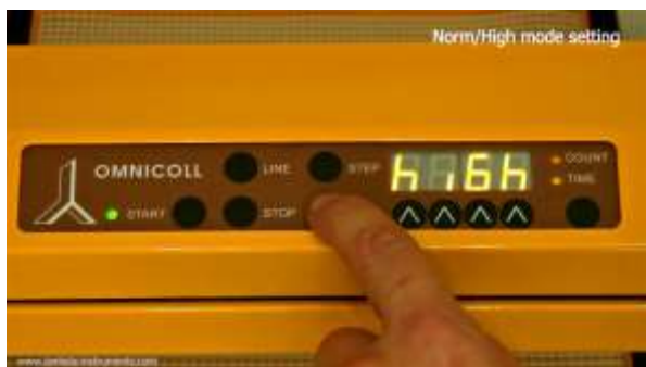
Abbildung 3.7-3 Bestätigen Sie die Auswahl "high" mit der Taste SET. Als akustisches Signal ertönt ein langer Beep.
