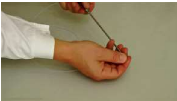
Abbildung 1.2-3 Schieben Sie den o-Ring über den PTFE-Schlauch. Schieben Sie anschließend den Schlauch durch die Schlauchführung.
