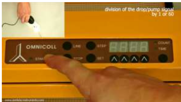
Abbildung 3.4-10 Drücken Sie die START Taste, während Sie gleichzeitig den Stromstecker des Fraktionssammler wieder einstecken.
