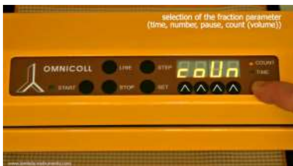
Abbildung 3.7-4 Auswahl des Parameters COUNT mit Hilfe der SET Taste: „coUn“ erscheint auf der Anzeige. Die COUNT LED leuchtete. Die TIME LED ist erloschen.
