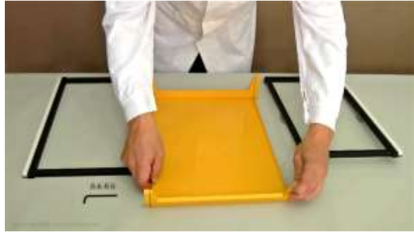
Abbildung 1.1-2 Schieben Sie das zweite Wannenblech in die Spalten an der gegenüberliegenden Seite der gelben Halterung.
