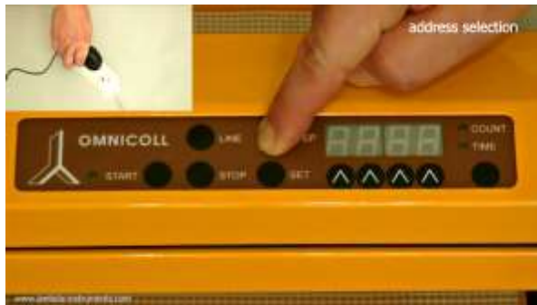
Abbildung 3.4-14 Drücken Sie anhaltend die Taste STEP und stecken Sie gleichzeitig das Netzteil des LAMBDA OMNICOLL Fraktionssammlers wieder ans Stromnetz.
