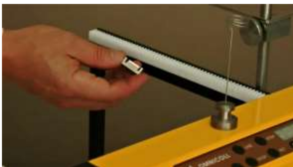
Abbildung 1.1-11 Legen Sie den mitgelieferten Magneten an der Stelle auf die rechte Innenseite des Rahmens, an der die Fraktionssammlung stoppen soll.
