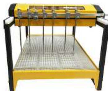
Abbildung 3.8-2 Beispiel Multistrom-Fraktionssammler zum Sammeln von 6 Strömen gleichzeitig in 96-Well-Platten. (Die Position der Kanülen ist innerhalb der Reihe anpassbar.)
