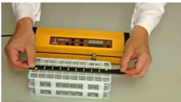
Abbildung 3.2-3 Legen Sie das kürzere, breitere Kodierband (x-Achse) in die Halterung ein.
