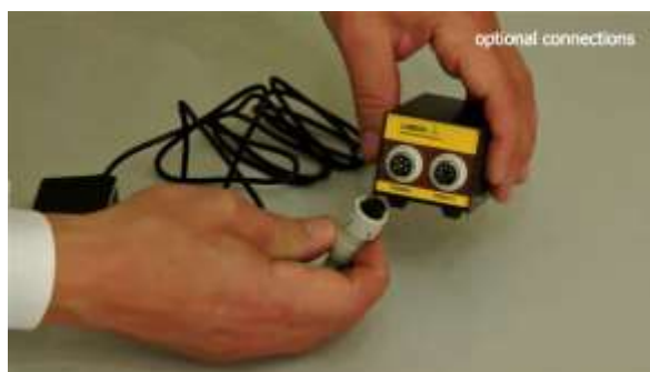
Abbildung 1.3-4 Am Kommunikationsmodul stecken Sie das Netzteil in die Buchse „POWER“ ein.
