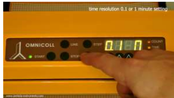
Abbildung 3.4-9 Sobald die gewünschte Zeitauflösung auf der Anzeige erscheint, bestätigen Sie diese durch Drücken der SET Taste.
