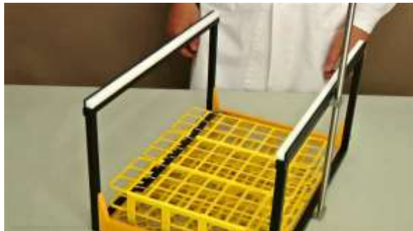
Abbildung 3.3-5 Auf dem längeren, schmaleren Kodierstreifen werden die weissen Linien für die Positionen der Reagenzgläser eingezeichnet.
