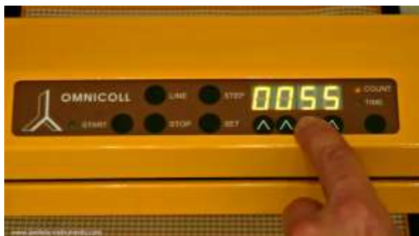
Abbildung 3.6-3 Wählen Sie am OMNICOLL Autosampler unterhalb des Displays mit den \wedge \wedge \wedge \wedge Tasten den gewünschten Wert für die Impulszahl, z.B. 55.
