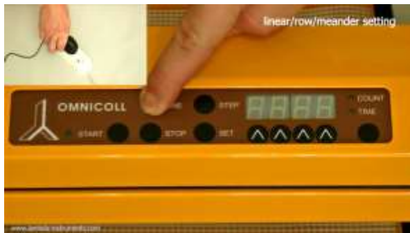
Abbildung 3.4-1 Drücken Sie anhaltend die Taste LINE und stecken Sie gleichzeitig das Netzteil des LAMBDA OMNICOLL Fraktionssammlers wieder ans Stromnetz.
