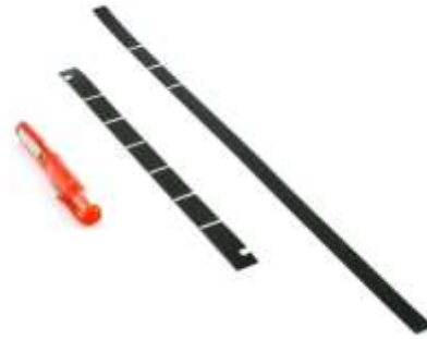
Abbildung 3.1-2 Die Positionen der Fraktionen werden mit einer weißen Linie auf dem Kodierstreifen (Magnetband) festgelegt.
