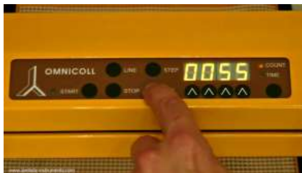
Abbildung 3.6-4 Bestätigen Sie die Impulszahl am OMNICOLL Autosampler mit der SET Taste
