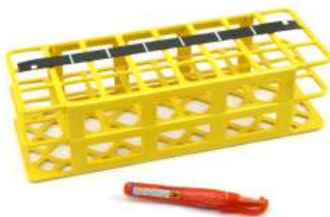
Abbildung 3.1-3 Anfang und Ende einer Reihe werden durch einen ~ 5 mm breiten und kurzen Strich (maximal die Hälfte der Kodierbandbreite) gekennzeichnet: Das Anfangssignal zeichnen Sie an der unteren Kante ein und das Endsignal an der oberen Kante des Kodierbands.
