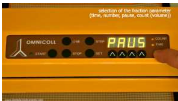
Abbildung 3.7-6 Wählen Sie mit der Taste SET den Parameter PAUSE, um Pausen zwischen den Probenahmen ins Programm einzugeben: „PAUS“ erscheint auf der Anzeige. Die COUNT LED leuchtet. Die TIME LED leuchtet.
