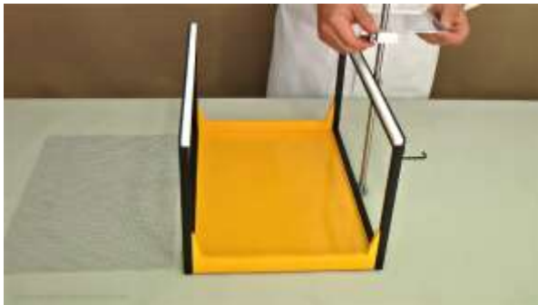
Abbildung 1.1-7 Schieben Sie die Metallstange durch die beiden Befestigungsmuttern auf der rechten Seite und schrauben Sie diese fest. Falls Sie eine LAMBDA Pumpe für den Autosampler installieren, fixieren Sie auch die Trägerplatte an der Metallstange.
