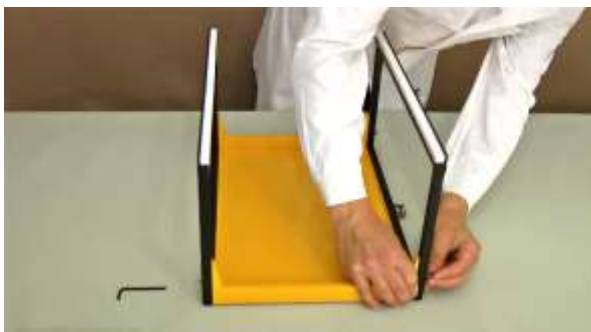
Abbildung 1.1-5 Befestigen Sie beide schwarzen Rahmen mit den mitgelieferten Schrauben (4 Stück) an der gelben Wanne.
