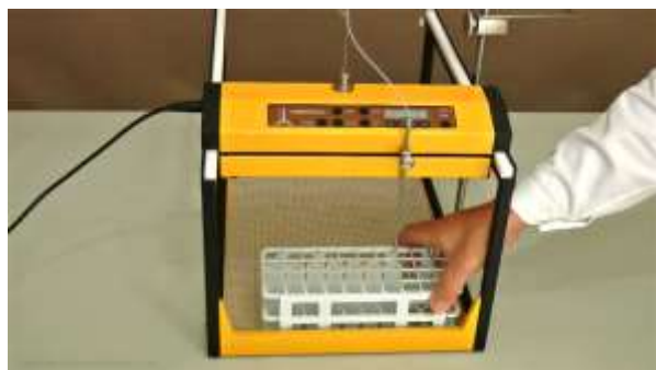
Abbildung 1.1-12 Platzieren Sie das Röhrchengestell auf die Fixiermatte, so dass das erste Reagenzglas unter der Schlauchspitze steht und die Kante des Röhrchengestells parallel zur vorderen Kante des Fraktionssammlers liegt.
