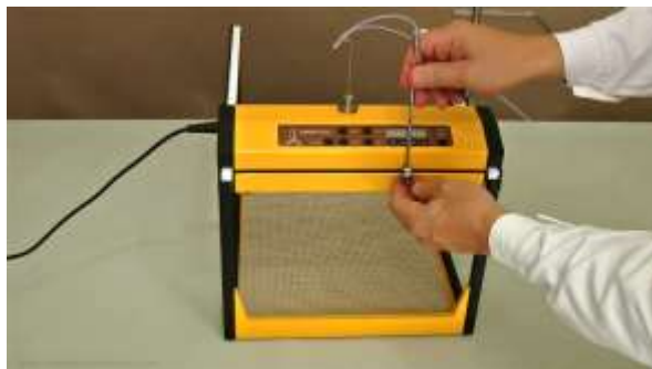
Abbildung 1.2-6 Schieben Sie die Schlauchführung durch die Rohrführung, die sich an der Front des OMNICOLL Fraktionssammlers befindet. Das Schlauchende wird ein paar mm oberhalb der Fraktionsbehälter (Röhrchen, Flaschen, ...) positioniert. Mit der Einstellschraube der Rohrführung wird die Schlauchführung befestigt. Lassen Sie dann den PTFE-Schlauch oben durch den Magnetschlauchhalter laufen.
