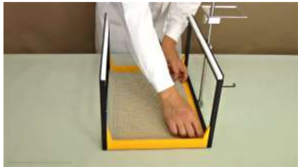
Abbildung 1.1-8 Legen Sie die Befestigungsmatte in die gelbe Wanne ein. Reinigen Sie die Matte mit einem feuchten Tuch. Stellen Sie sicher, dass die Matte vor dem Gebrauch trocken ist.
