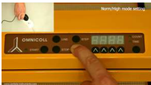
Abbildung 3.7-1 Drücken Sie die Taste SET am OMNICOLL Autosampler und schliessen Sie gleichzeitig das Steckernetzteil an das Stromnetz an.
