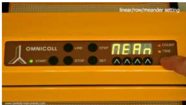
Abbildung 3.4-3 "MEAn" für den Betriebsmodus „Mäander“ erscheint auf dem Display des Fraktionssammlers.
