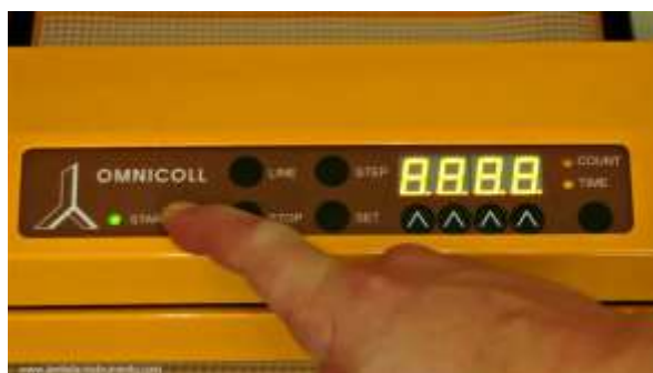
Abbildung 3.6-6 Am OMNICOLL drücken Sie die START Taste, um den Autosampler zu starten. Falls der Schlauch nicht mit Flüssigkeit gefüllt gewesen ist, nehmen Sie eine zweite Probe.
