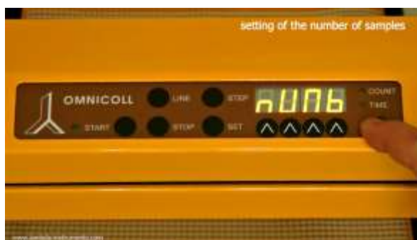
Abbildung 3.7-7 Wählen Sie mit der Taste SET den Parameter NUMBER, um die Anzahl der Proben einzugeben: „nuMb“ erscheint auf der Anzeige. Die COUNT LED ist erloschen. Die TIME LED ist erloschen.
