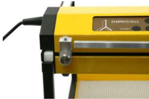
Abbildung 3.8-6 Setzen Sie die Vorrichtung für die multiple Fraktionssammlung (den Stabhalter) auf die Schraube am beweglichen Arm.
