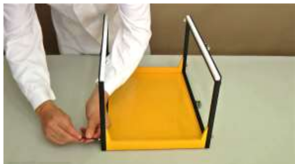
Abbildung 1.1-6 Ziehen Sie die Schrauben mit dem mitgelieferten Sechskantschlüssel fest.
