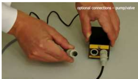
Abbildung 1.3-6 Bei Bedarf können Sie auch eine Pumpe oder ein Ventil an die Buchse "PUMP / VALVE" des Kommunikationsmoduls anschliessen.
