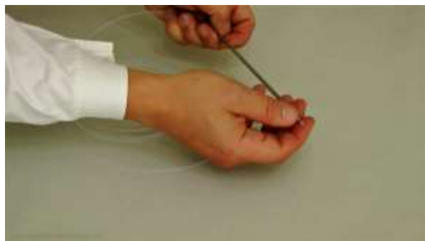
Abbildung 1.2-4 Stellen Sie sicher, dass der PTFE-Schlauch 5 mm aus der Schlauchführung herausragt, damit sich später höchstens am PTFE-Schlauchende Tropfen bilden.
