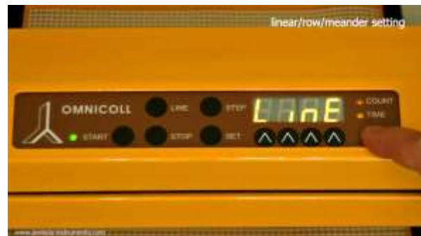
Abbildung 3.4-4 "LinE" steht für den Betriebsmodus „Linear“ beim Sammeln der Fraktionen bzw. Proben.
