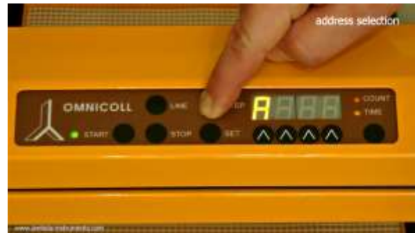
Abbildung 3.4-15 Auf der Anzeige des Fraktionssammlers erscheint zuerst "A" und danach zwei Ziffern, die die Nummer zwischen 00 und 99 als aktuelle Geräteadresse anzeigen.
