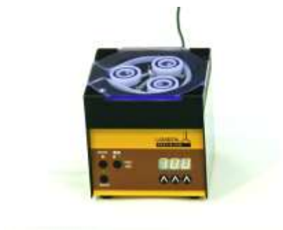
Abbildung 3.6-5 Wählen Sie an der LAMBDA Schlauchpumpe die Pumpgeschwindigkeit mit den \wedge \wedge \wedge Tasten (z.B. 700) und mit der Richtungstaste ( \blacktriangleleft \blacktriangleright ) die Fliessrichtung. Schalten Sie die Schlauchpumpe mit der ON/OFF Taste ein.
