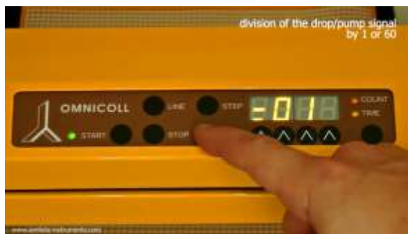
Abbildung 3.4-13 Bestätigen und speichern Sie den Teiler durch Drücken der SET Taste.
