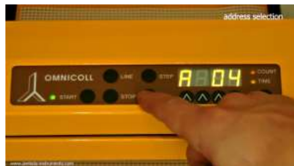
Abbildung 3.4-17 Bestätigen und Speichern Sie die Geräteadresse durch Drücken der SET Taste am Fraktionssammler.
