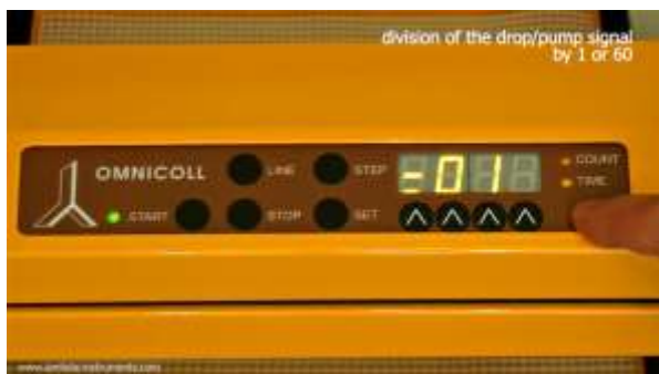
Abbildung 3.4-12 Wählen Sie durch Drücken der COUNT/TIME Taste (in der unteren rechten Ecke des Bedienfelds) den gewünschten Teiler (1 oder 60).
