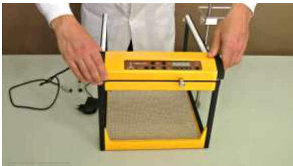
Abbildung 1.1-9 Auf dem Rahmen platzieren Sie jetzt die mobile Kontrolleinheit: Die Kontrolleinheit muss dabei im gleichen Abstand von den beiden vorderen Kanten des Fraktionssammlers stehen. Die Zahnräder der Steuereinheit müssen korrekt in die Zähne beider Schienen greifen. Stellen Sie sicher, dass die Bewegung der Steuereinheit entlang der Schienen durch nichts beeinträchtigt wird.
