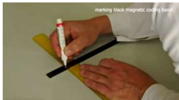
Abbildung 3.3-2 Zeichnen Sie die weißen Linien (Positionen) mit dem Stift an den vormarkierten Stellen. Reservieren Sie ~ 2 cm des Kodier-bandes für die Anfangs- und Endsignale.
