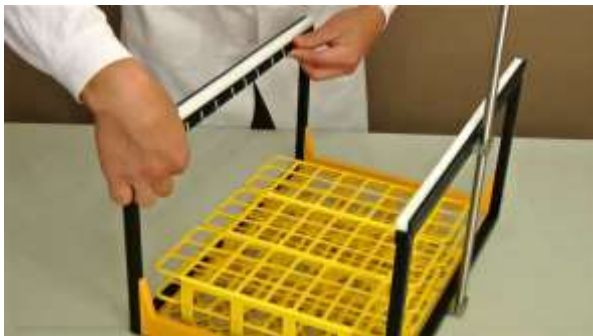
Abbildung 3.2-1 Befestigen Sie das längere, schmalere Kodierband (y-Achse) an der linken Innenseite des Metallrahmens unterhalb der gezahnten Bahn. Die erste Kodierlinie sollte ~ 10 cm hinter der Front des Rahmens liegen.
