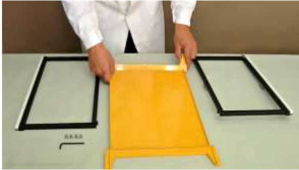
Abbildung 1.1-1 Schieben Sie das erste Wannenblech in die Spalten an einer der kürzeren Seiten der gelben Halterung.
