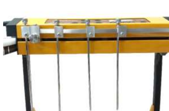
Abbildung 3.8-10 Führen Sie die Schlauchführungsrohre durch die Schlauchführungsrohrhalter, die sich auf dem waagrecht Stab befinden. Adjustieren Sie die Schlauchführungsrohre gemäss der Höhe Ihrer Sammelbehälter. Fixieren Sie die Schlauchführungsrohrhalter mit dem Sechskantschlüssel auf dem Stab.
