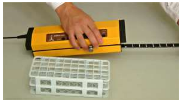
Abbildung 3.2-4 Schieben Sie die Halter mit dem Kodierband für die x-Achse in die Seitenöffnung der mobilen Kontrolleinheit.
