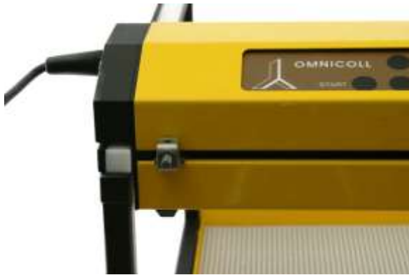
Abbildung 3.8-5 Schrauben Sie die Schlauchführungshalterung vorne am beweglichen Arm des OMNICOLL Fraktionssammlers ab.
