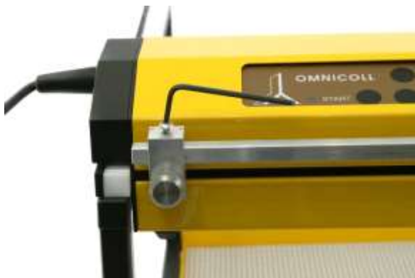
Abbildung 3.8-9 Oben auf dem Stabhalter befindet sich eine Schraube: Schrauben Sie mit dem Sechskantschlüssel den Stab in der Stabhalterung fest. (Z.B. mit einem dünnen Spatel kann die Schraube durch den beweglichen Arm gedrückt werden.)
