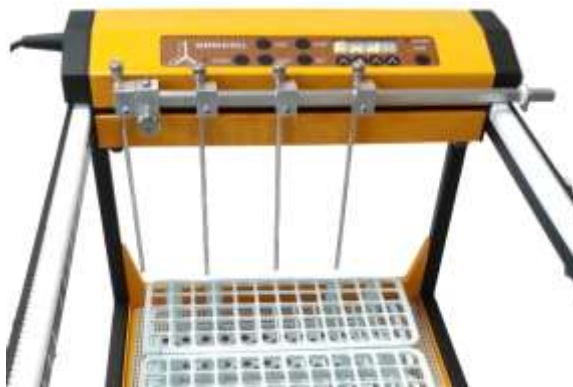
Abbildung 3.8-12 Platzieren Sie den Schlauchführungshalter über den ersten Fraktionsbehälter jedes zu sammelnden Stroms. Beispiel: 4 Ströme werden in einer Reihe von Reagenzgläsern gesammelt: 1. Strom: erste Schlauchführung über Reagenzglas Nr. 1; 2. Strom: zweite Schlauchführung über Reagenzglas Nr. 4, 3. Strom: dritte Schlauchführung über Reagenzglas Nr. 7, 4. Strom: vierte Schlauchführung über Reagenzglas Nr. 10
