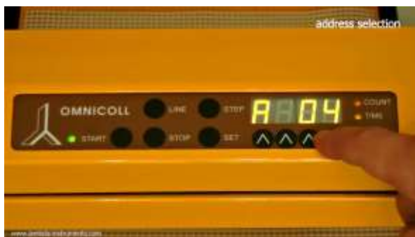
Abbildung 3.4-16 Mit den Tasten \wedge \wedge \wedge \wedge stellen Sie am Fraktionssammler die gewünschte Geräteadresse zwischen 00 und 99 ein.
