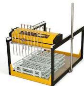
Abbildung 3.8-3 Beispiel Fraktionssammler mit Reagenzglasgestellen für 20 parallele Ströme. (Die Position der Kanülen ist innerhalb der Reihe nicht verstellbar.)
