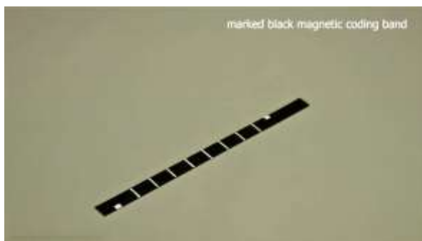
Abbildung 3.3-3 Markieren Sie das Anfangssignal am unteren Rand (mindestens ~ 6 mm vor der ersten Linie) und das Endsignal am oberen Rand (mindestens ~ 6 mm nach der letzten Linie) des Kodierstreifens.
