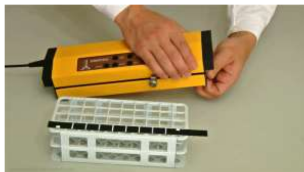
Abbildung 3.3-4 Legen Sie das fertige x-Kodierband in die Halterung in der mobilen Steuereinheit des Fraktionssammlers. Die weißen Markierungen liegen dabei nach oben.
