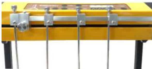
Abbildung 3.8-11 Setzen Sie den Schlauchführungshalter in die Position und sichern Sie ihn mit der Innensechskantschraube mit dem entsprechenden Steckschlüssel (Inbusschlüssel).
