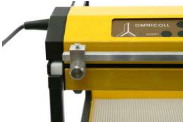
Abbildung 3.8-7 Legen Sie die rechteckige Stab waagrecht in den Stabhalter.
