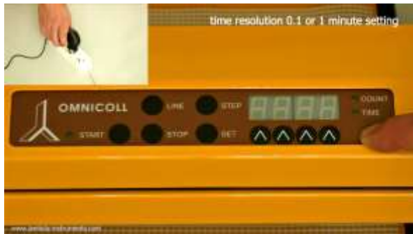
Abbildung 3.4-6 Drücken Sie die Taste COUNT/TIME (rechts unten, unterhalb der Leuchtdioden COUNT und TIME) während Sie gleichzeitig den Stromstecker des Fraktionssammler wieder einstecken.
