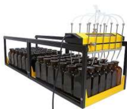
Abbildung 3.8-4 Beispiel OMNICOLL Fraktionssammler mit einer Verlängerung zum Sammeln von 12 simultanen Strömen (2 x 6) in 250 ml Glasflaschen. (Die Position der Kanülen ist innerhalb der Reihe nicht verstellbar.)
