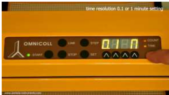
Abbildung 3.4-8 Durch die Betätigung der Taste COUNT / TIME (die sich unterhalb der COUNT und TIME LEDs befindet) wählen Sie die gewünschte Zeitauflösung: „0.1 M“ für Schritte von 0.1 Minuten oder „1 M“ für Schritte von 1 Minute.
