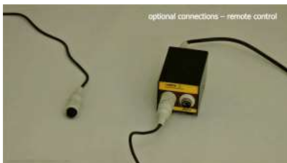
Abbildung 3.6-1 Schliessen Sie die LAMBDA Schlauchpumpe mit dem Fernsteuerungskabel (#4810-s) an das Kommunikationsmodul (#6911 oder #6929) an.
