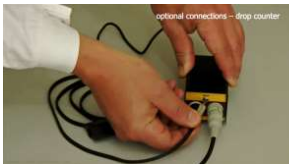
Abbildung 1.3-2 Am Kommunikationsmodul stecken Sie in die Buchse „DROP“ das Kabel des Tropfenzählers ein.
