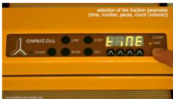
Abbildung 3.7-5 Auswahl des Parameters TIME mit Hilfe der SET Taste: „tiMe“ erscheint auf der Anzeige. Die COUNT LED ist erloschen. Die TIME LED leuchtet.
